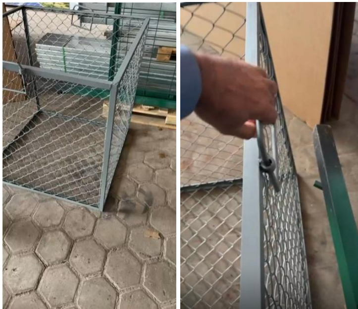
Figura 02 - Confeção de gaiola com tela galvanizada para alambrados com alça retrátil instalado na Av Rio de Janeiro c/ Av. Guaporé.
