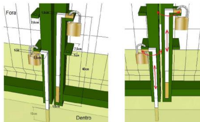
Imagem 04- detalhe do porta cadeado tipo 2.0 (com ferrolho duplo)
