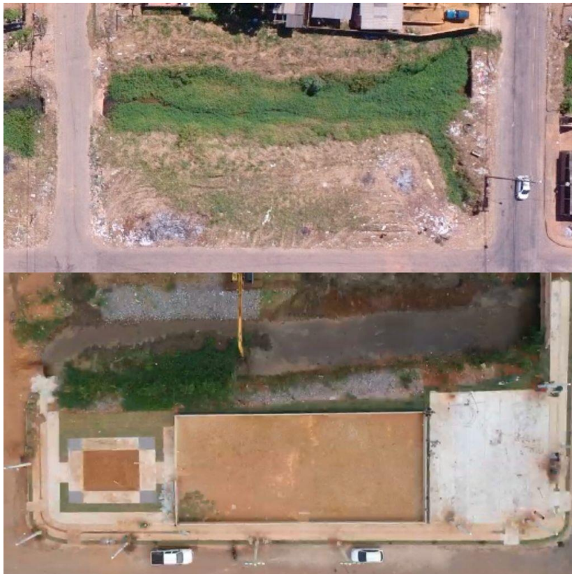
Figura 02- 1ª etapa executada com bancos e mesas de xadrez, campo de areia, e playground com casinha de madeira.
